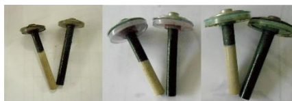
Gambar 1. Kondisi Elektroda Setelah Elektrolisis ; dari Kanan Elektroda Besar ( E_b ), Elektroda Sedang ( E_s ), dan Elektroda Kecil ( E_k )
