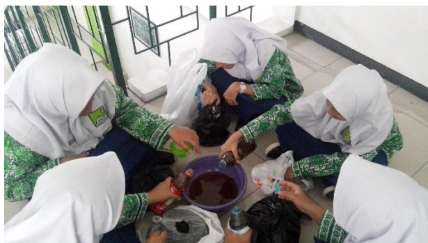
Gambar 3. Pemurnian Minyak Jelantah dengan Arang
