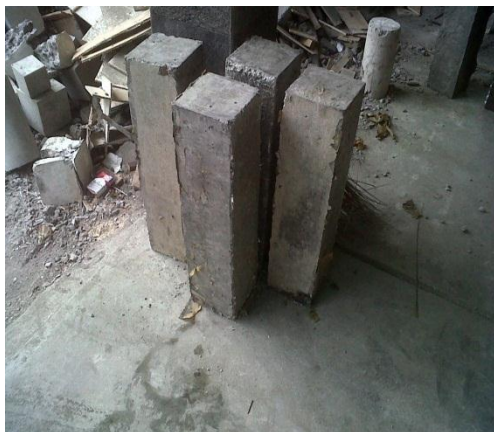
Gambar 2. Hasil Cetakan Beton
