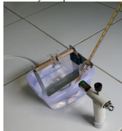
Gambar 4. Rangkaian Alat Penentuan Koefisien Pemuaian Panjang Aluminium (Al) dengan Metode Kisi difraksi saat Pengambilan Data.
