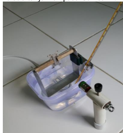
Gambar 4. Rangkaian Alat Penentuan Koefisien Pemuaian Panjang Aluminium (Al) dengan Metode Kisi difraksi saat Pengambilan Data.
