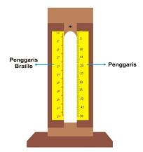
Gambar 6 Rancangan Akhir Kit Percobaan Pegas untuk Siswa Tunanetra
