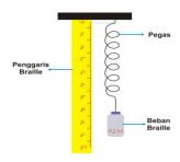
Gambar 4 Rancangan Kit Percobaan Pegas untuk Siswa Tunanetra
